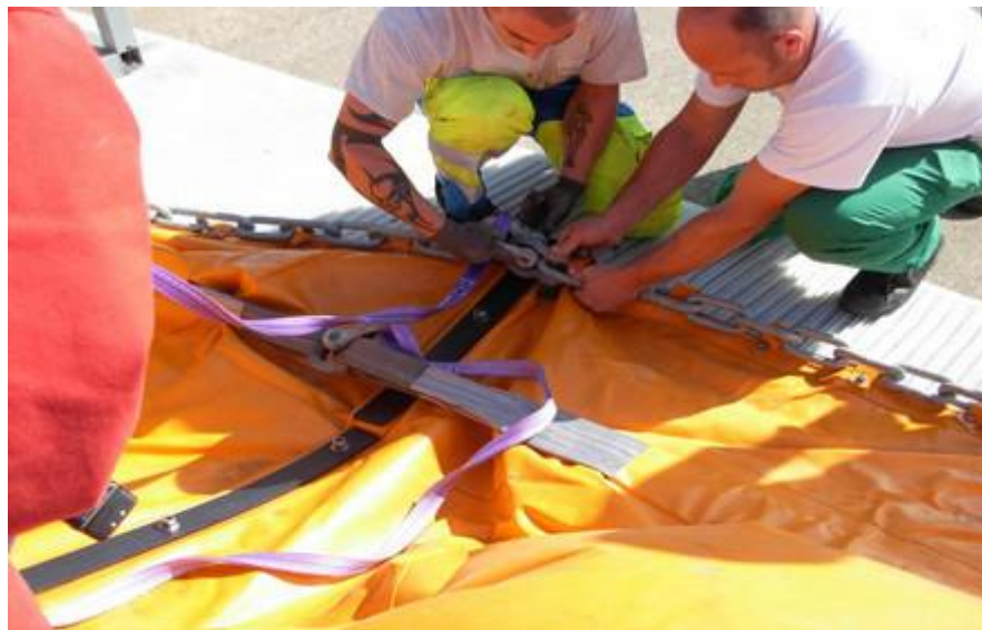
Raccordement des liaisons de reprise d'efforts : chaîne et sangle
