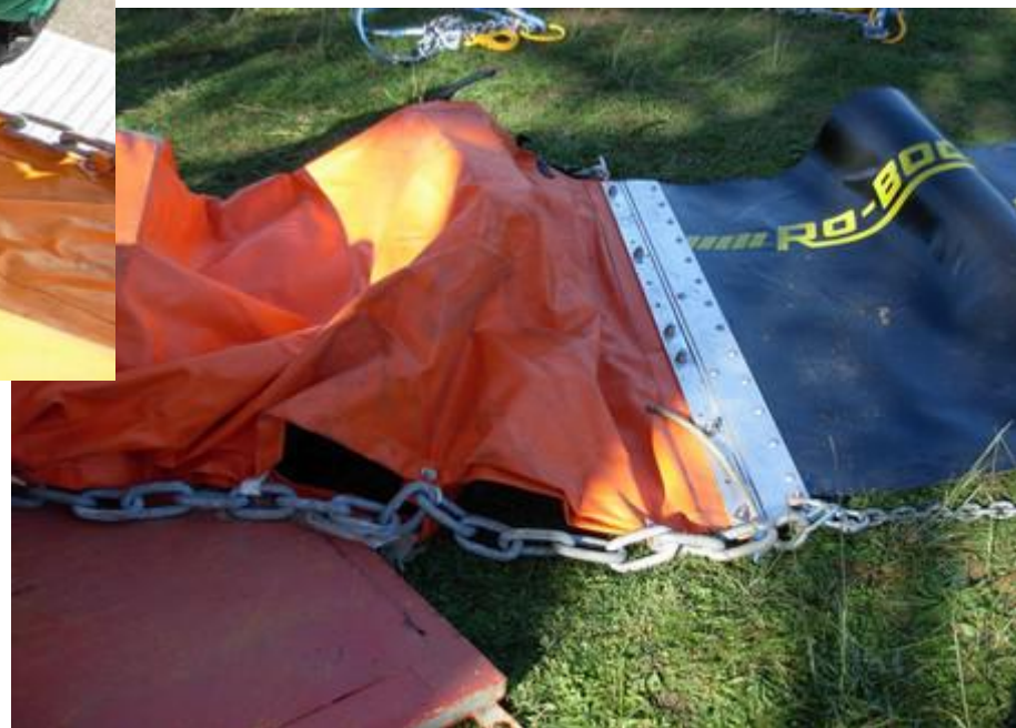
Raccordement de deux tronçons de barrages différents
